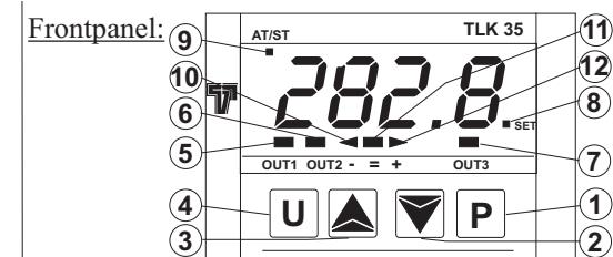
TLK35 er en digital microprocessorstyret controller med ON/OFF, neutral zone ON/OFF eller PID kontrol.
